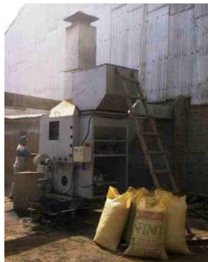
玻利维亚Yapacani的稻壳燃烧炉
