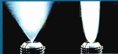
施托克的SwirlFlash®系统的正常工作条件是：水压130bar，水温180°C。
